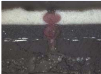
Galvanisiertes Stahlblech, mit Gasblasen in der Zinkschicht. Durchmesser ca. 20 µm
