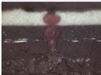
金属镀层的镀锌层上， 气泡直径约20 μm
