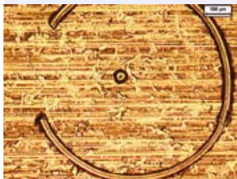
钢上PVD镀铬层的 可能腐蚀点，50 x
