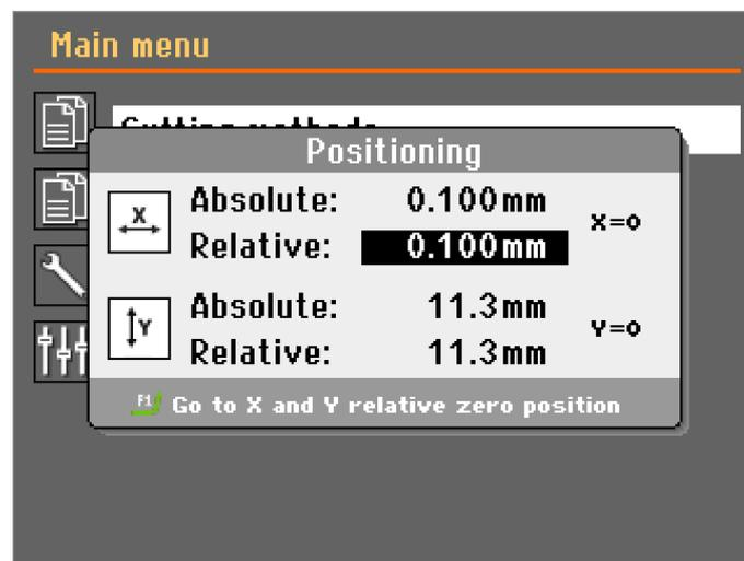
1. Mueva la pieza de trabajo a la posición de inicio correcta, cerca del disco de corte, con el botón de accionamiento mantenido y las teclas de posicionamiento.
