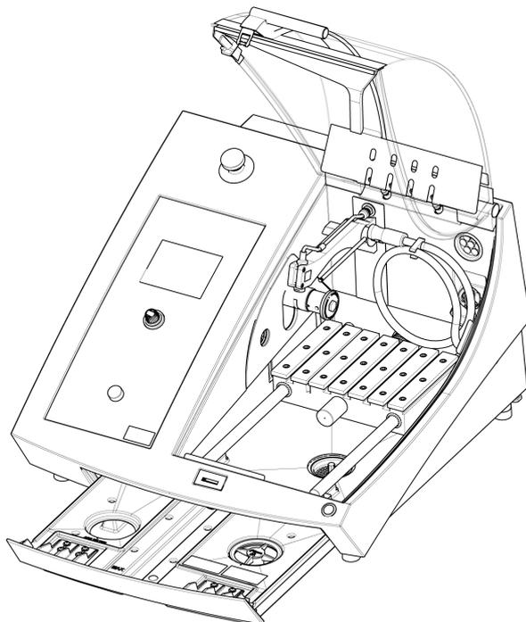
1. Assicurarsi che il serbatoio del refrigerante sia in posizione sotto la camera.
