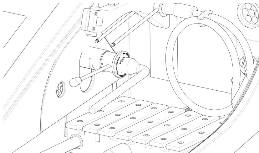
3. Inserire il perno nel foro dell'albero del disco di taglio.
