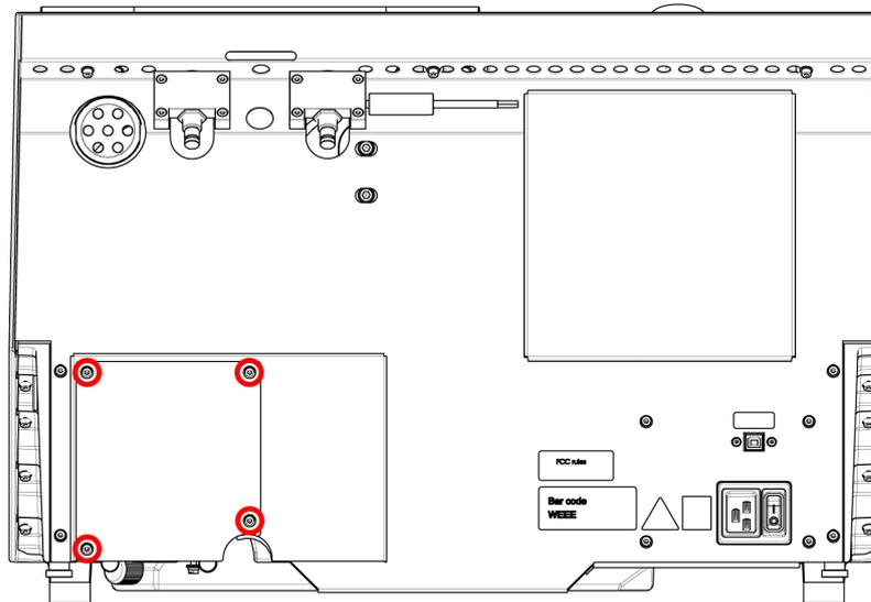
1. Rimuovere le quattro viti della placca di protezione sul retro della macchina.
