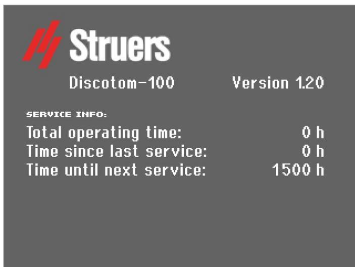
Dopo 1.000 ore di funzionamento (o un determinato numero di mesi) un messaggio a comparsa ricorda che è necessario programmare un intervento di manutenzione. Superate le 1.500 ore di utilizzo, il messaggio a comparsa cambierà per avvisare l'utente che il termine massimo per l'intervento di assistenza è scaduto. Contattare l'Assistenza Struers.
