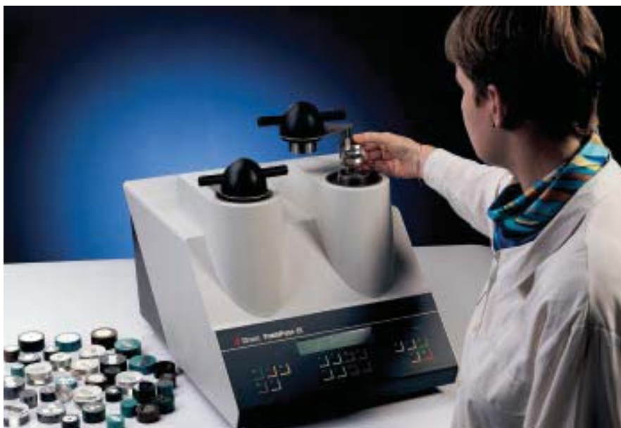
ProntoPress-20 mit den beiden Zylindern ist unentbehrlich, wenn große Probenreihen oder Proben in verschiedenen Durchmesser eingebettet werden sollen
