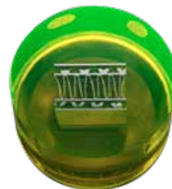
通过将 EpoDye、荧光染料与树脂混合,在荧光灯下检查试样时,可轻松识别孔洞和裂缝。
